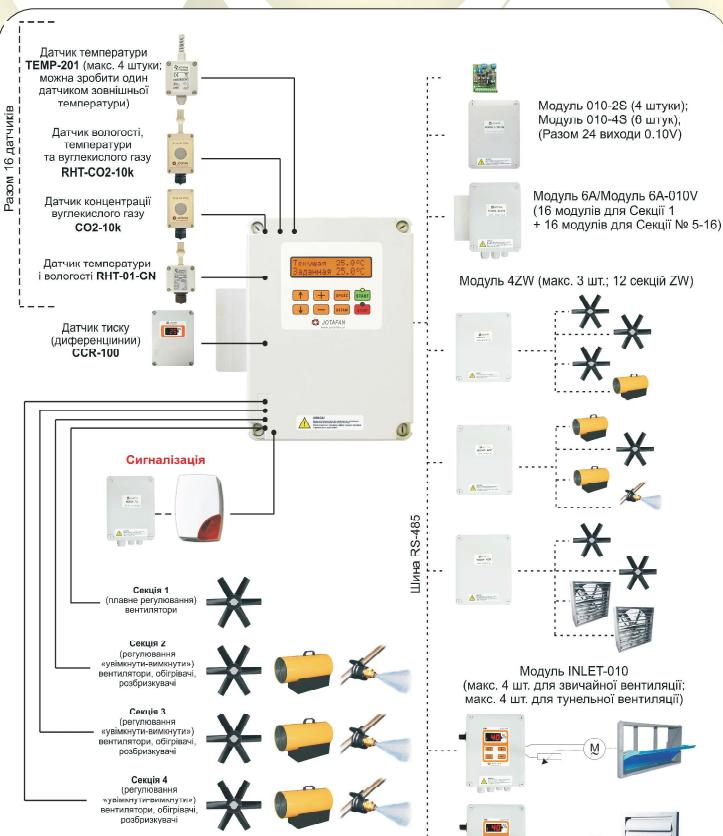
Схема поєднання регулятора VIRGO з датчиками і модулями
